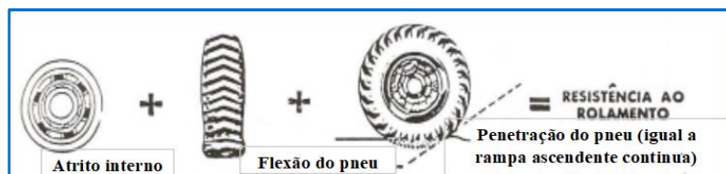
Figura 33: Resistência ao rolamento Fonte: TADEO JAWORSKI, 2011, adaptado por Autor ,2024.
