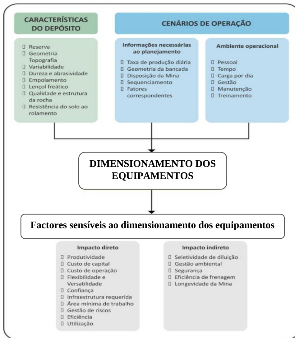
Figura 36- Considerações para a seleção de Equipamentos e Factores Sensíveis ao Dimensionamento dos equipamentos.
