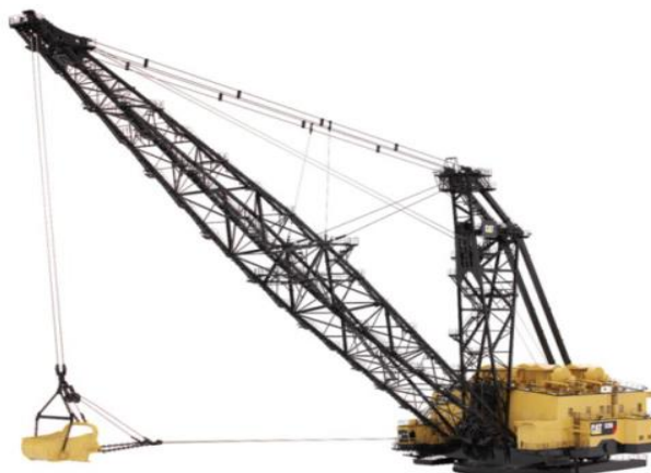
Figura 24 : Drag-line -Cat 8200, (24 a 34 m³).
