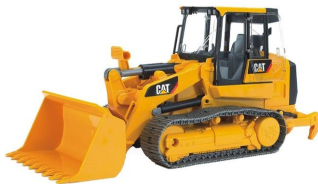
Figura 26:Pá-carregadeira sobre esteiras,Cat 953D,(1,85m³).
