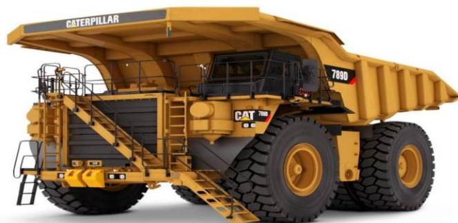
Figura 29 : Camião basculante rígido (Fora de estrada), Cat 789D, (181t). Fonte: Barloworld Equipamentos | Especificações (barloworld-equipment.com).
