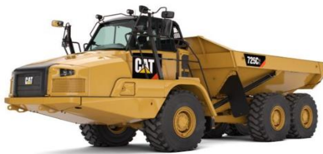
Figura 28 : Camião basculante articulado, Cat 725C, (24t). Fonte: Barloworld Equipamentos | Especificações (barloworld-equipment.com),2024.
