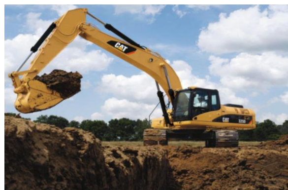
Figura 15: Escavadeira Cat 325D, (1,19m³) Fonte: SM do Cacuilo, 2022
